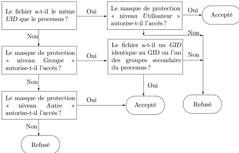
FIGURE 2.3 – Algorithme de vérification des droits d'accès sous UNIX
