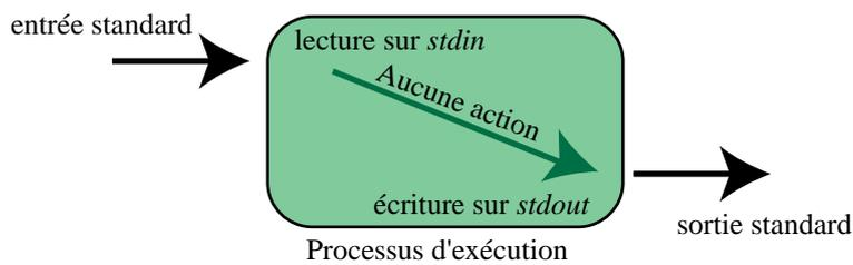
FIGURE 2.5 – Fonctionnement de la commande « `cat` »
