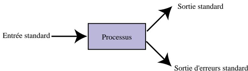
FIGURE 1.3 – Entrées/Sorties d'un processus
