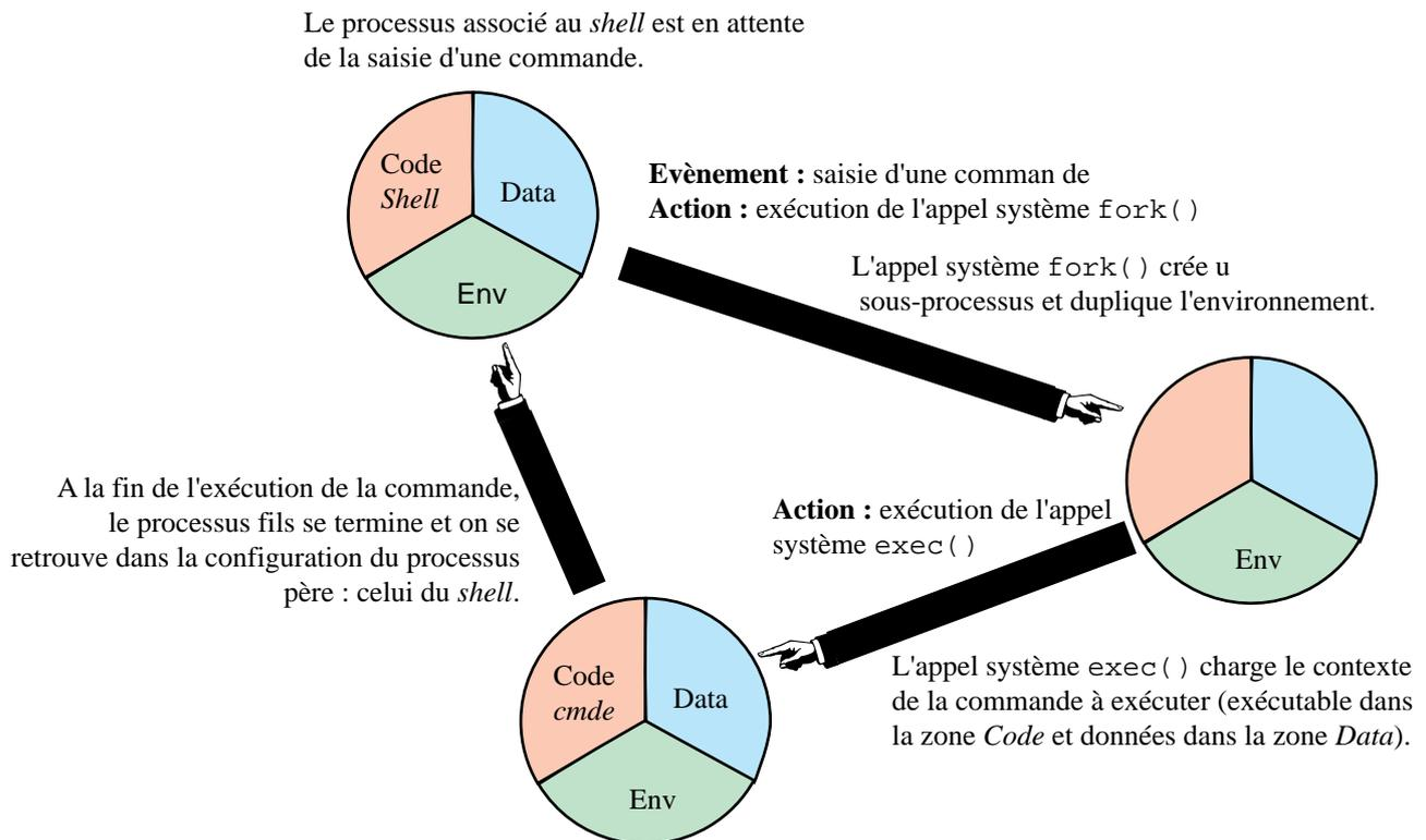
FIGURE 4.2 – Exécution d'une commande sous UNIX
