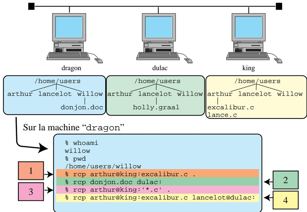
FIGURE 3.4 – Exemple d'utilisation de la commande « rcp ».
