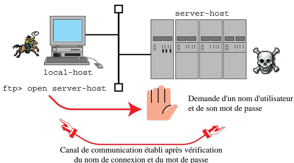
FIGURE 3.2 – Etablissement d'une connexion ftp
