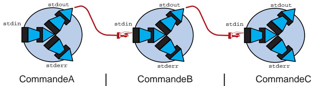
FIGURE 4.3 – Enchaînement de commandes, mécanisme du *pipe*.
