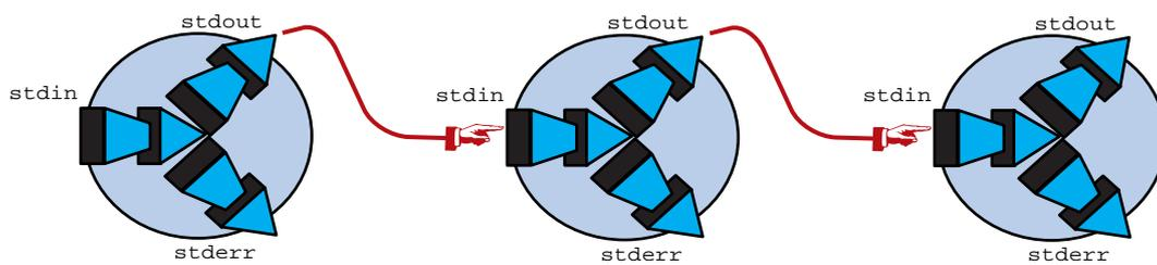
FIGURE 1.4 – Principe des filtres sous UNIX
