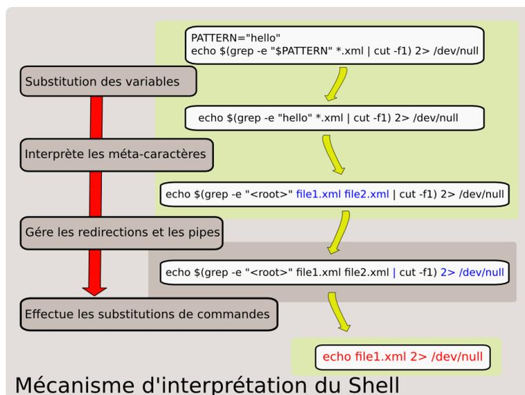
FIGURE 4.1 – Mécanisme d'interprétation du Shell
